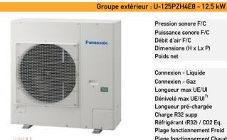
Pression sonore F/C dB(A) 55 / 55 Puissance sonore F/C dB(A) 73 / 73 86,0 / 78,0 Débit d'air F/C m³/min Dimensions (H x Lx P) 996 x 980 x 370 mm Poids net 84 ka Connexion - Liquide 3/8 (9,52) Pouces (mm) 5/8 (15,88) Connexion - Gaz Pouces (mm) Longueur max UE/UI 5 ~ 100 Dénivelé max UE/UI7) 15/30 Longueur pré-chargée m 30 Charge R32 supp 40 g/m Réfrigérant (R32) / C02 Eq. 3,00 / 2,03 kg/T
