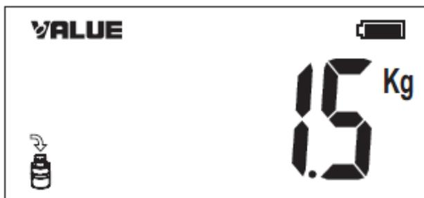
5. Quand la quantité voulue de réfrigérant a été transférée, la vanne solénoïde va couper automatiquement et la balance affichera le poids brut du réservoir de réfrigérant.
