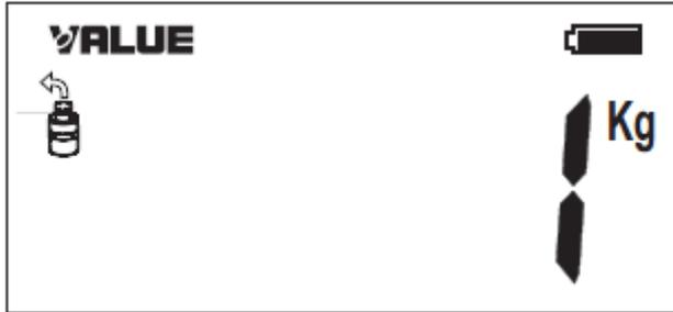
5. Lorsque la quantité requise de réfrigérant a été transférée, la vanne solénoïde va se fermer et le poids brut du réservoir va s'afficher. L'arrêt se fait automatiquement.
