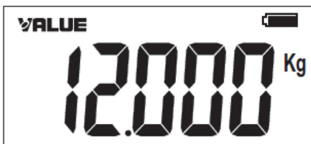
4. presser la touche « CHARGE ». L'indicateur de charge apparait. Entrer le poids à charger et presser le bouton « ENTER ».
