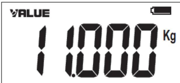
6. Si la balance n'est pas connectée à l'alimentation en courant alternatif, la vanne solénoïde ne fonctionnera pas. Le bruiteur de la balance donnera l'alarme lorsque la charge se termine (réfrigérant  $\leq 0.05\text{kg}$ ). Dans ce cas, arrêtez la charge manuellement. Pressez sur la touche « ENTER » pour afficher le poids brut du réservoir.
