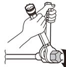
3 Serrer l'écrou évasé après avoir inséré le tuyau engagé avec l'écrou évasé dans le centre du tuyau de l'unité intérieure.
