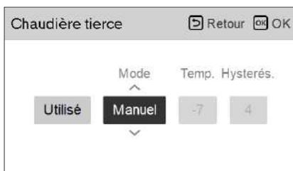
Si le mode de cette fonction est réglé sur « Auto », vous pouvez régler la température de la chaudière et l'hystérésis, respectivement.
