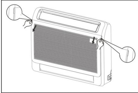
2- Retirez les vis et soulevez le capot de protection de sa position:
