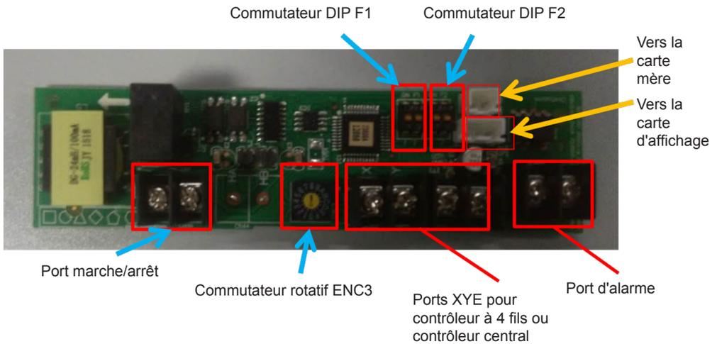
1. Le commutateur rotatif ENC3 et le commutateur DIP F1 sont destinés au réglage de l'adresse réseau ;
