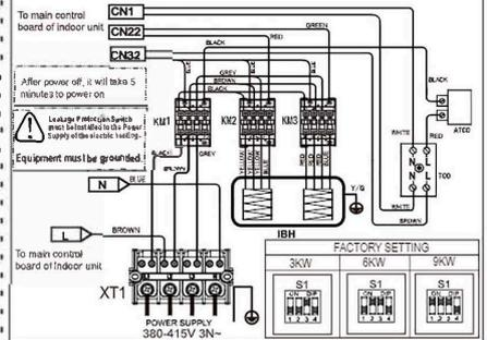
Figure2: 1-Phase 3KW IBH(One step control)
